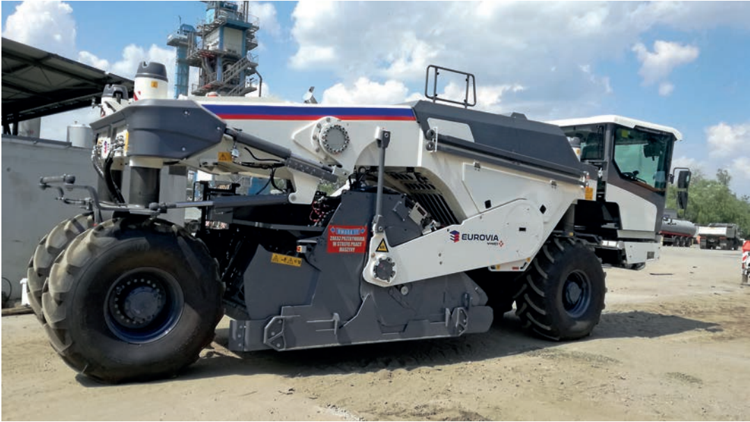
Fot. 1. Recyklar wykorzystywany do wykonywania mieszanek MCE in-situ
