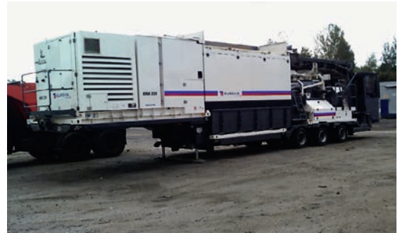
Fot. 2. Mobilna wytwórnia służąca do produkcji mieszanek MCE z dwóch rodzajów materiałów sypkich, cementu, emulsji asfaltowej i wody
