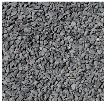
Fot. 7. Mozaika kruszywowa; źródło: broszura Komisji Emulsyjnej Powierzchniowe utrwalenia, www.pswna.pl/komisja-emulsyjna/
