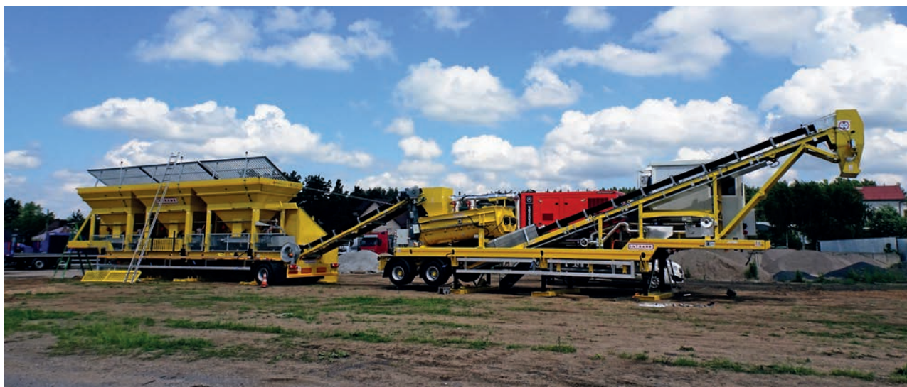
Fot. 2. Mobilna instalacja do produkcji mieszanek mineralno-emulcyjnych
