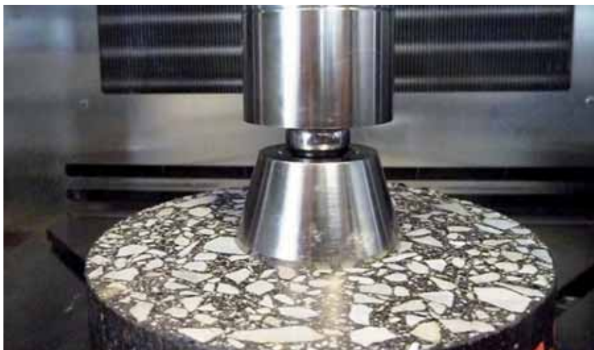
Fot. 2. Stempel do badania penetracji dynamicznej asfaltu lanego na próbkach o średnicy 150 mm przy temperaturze +50^{\circ}\text{C} zgodnie z TP Asphalt St-B 07 Teil 25A
