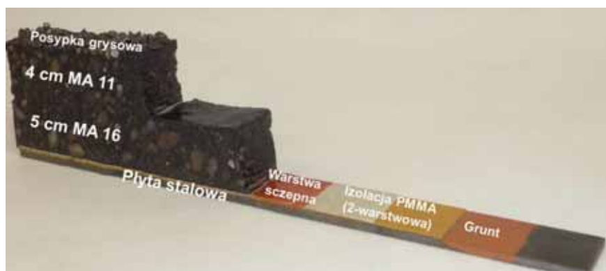
Fot. 1. Poglądowy przekrój nowoczesnej systemowej nawierzchni mostowej z dwuwarstwowym układem konstrukcji z asfaltu lanego wraz z izolacją natryskową z PMMA na płycie stalowej
