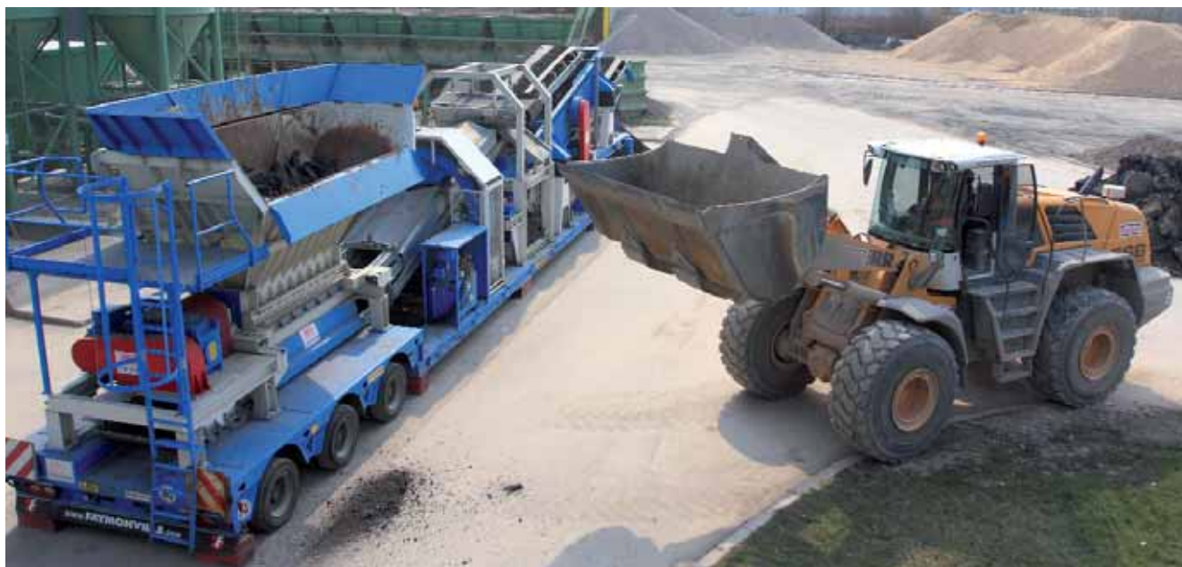
Granulator – urządzenie do przetwarzania destruktu asfaltowego w granulatu. Właścicielem urządzenia jest firma POLHILD z Kobytki
