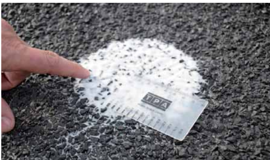
Fot. 6. Badanie makrotekstry warstwy ścieralnej z asfaltu lanego metodą piasku kalibrowanego wykazało wartości MTD znacznie powyżej 1,8 mm
